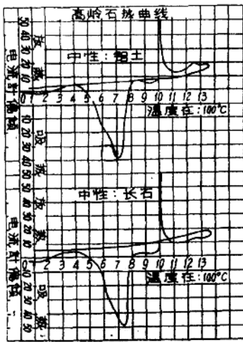
图2 高津及其同事发表的高岭石最早 的DTA曲线(“热曲线”)(佐远，1923)
