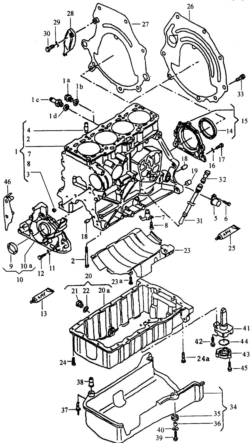
主组:1 发动机——带活塞的气缸体,油底壳
