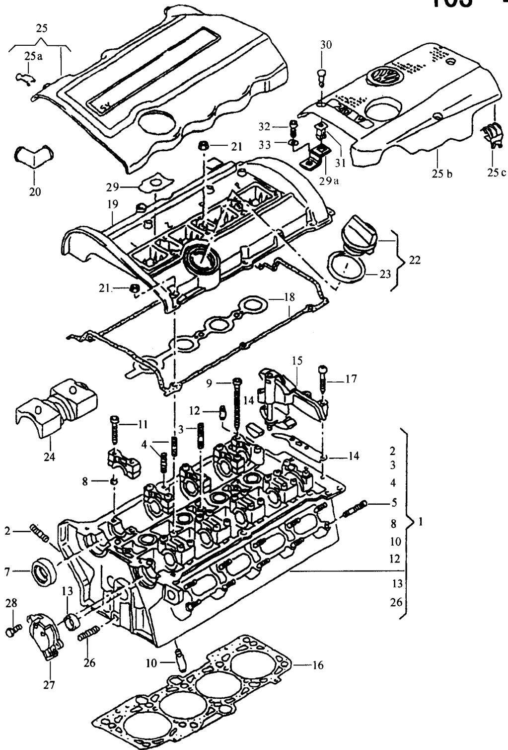
主组:1 发动机——气缸盖,气缸盖罩盖(1.8L)
