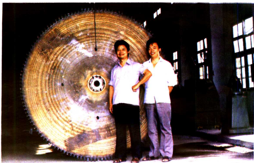
1989 年研制成功的大型圆盘( \Phi 2200\text{mm} )锯片,是我国目前最大的金刚石锯片(作者与阎亚萍合影)
