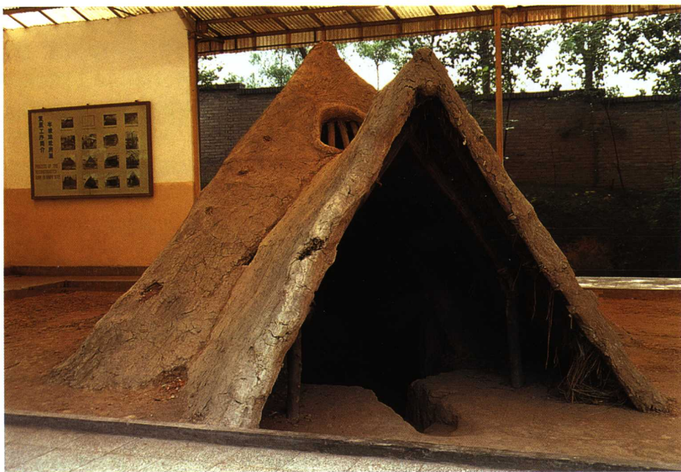
照片2 距今五千年前父系氏族社会时的以父系家庭为单位的半地下住宅，已开始使用土木混合结构的技术，火塘位于房子的中央。房顶上的小窗口，除采光通风的功能外，还起到排烟的作用（图为现代学者推测建造的房子）。
