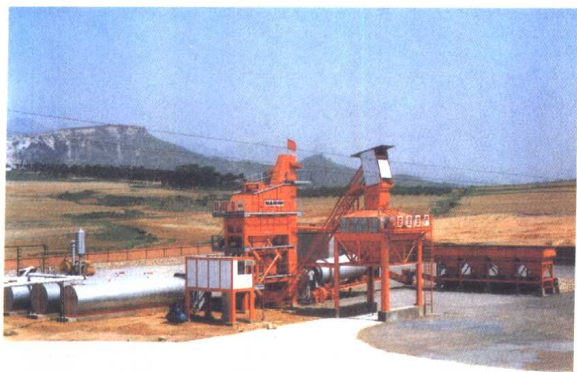
沥青拌合站大型拌合机
