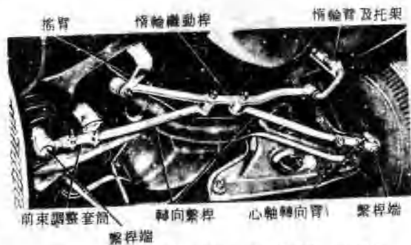
圖 1-17 轉向連桿組設計—惰輪臂式獨立前懸吊。
