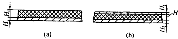
图 1.5 自由层阻尼处理和约束层阻尼处理结构示意图
