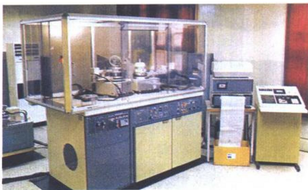
图 1-7 X 射线衍射仪，用于测定晶体结构
