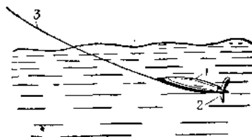
图 4 测量海船和河船航行速度的计程仪
