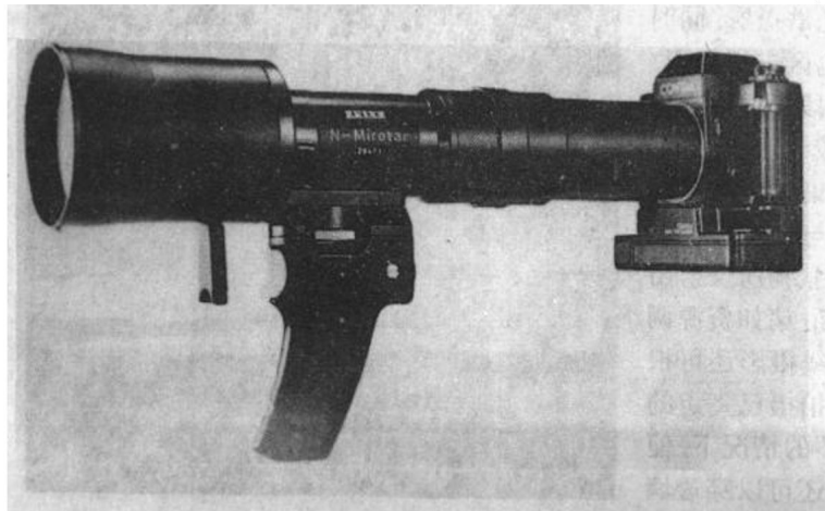
图1 微光摄影机内装有反射式远离镜头和三级光线放大器,由两枚藏于手柄内的1.5伏电池推动,可使光度增大八万倍,由微距镜头将影象投到照相机的胶卷平面上而成为可见像,其光度比用f1.4镜头所收集的像的光度强2500倍。
