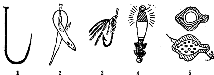
图21-12 不同钓捕作用的钓钩装置图
