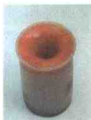
图10.1-5 液态的蜡在凝固时体积缩小，中间凹陷下去。
