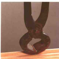
这种夹钳用于夹除钉子、钢钉等，也可用于剪断金属丝。
