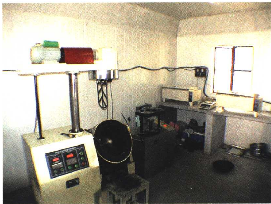
▲ 外环线沥青混合料施工现场实验室，对沥青混合料质量进行现场检测
