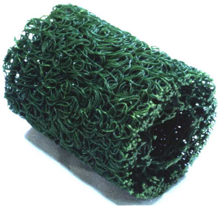
▲ 外环线运用的新型路基排水材料
