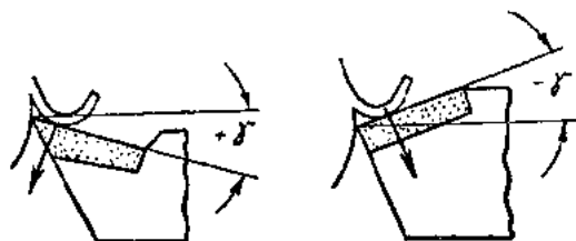
第 2 圖 使用正前角及負前角車刀時發生切屑的情況
