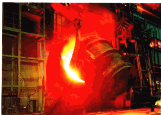
◁ 一炼钢厂 120 吨转炉
