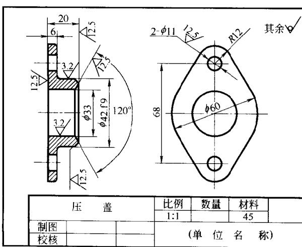
图 0-2 压盖的零件图
