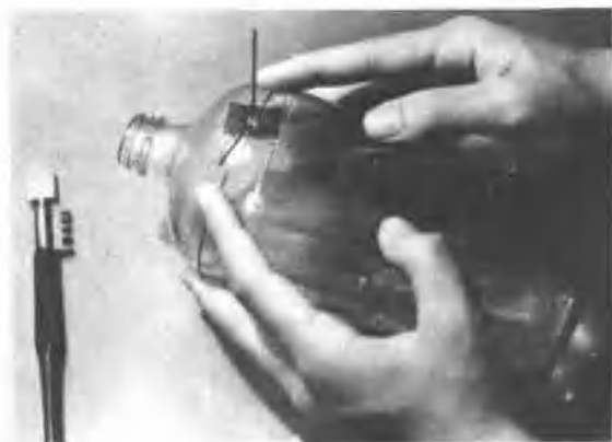
照片圖 7 將發熱綫繞在瓶身，共同穿過雲母片，然後把兩綫口分列左右，準確地套在已有罅紋的位置上。
