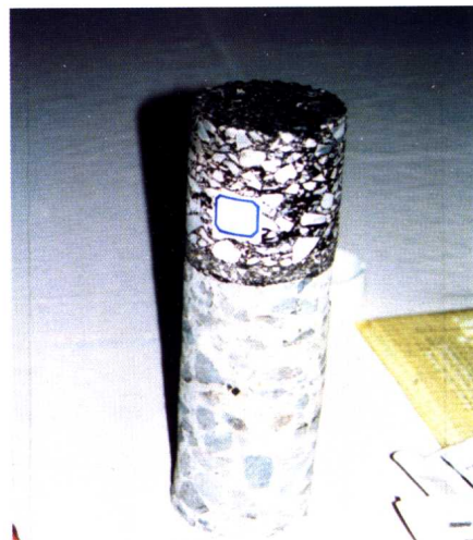
远东大道实验的透层油和下封层将面层与基层紧密连接在一起
