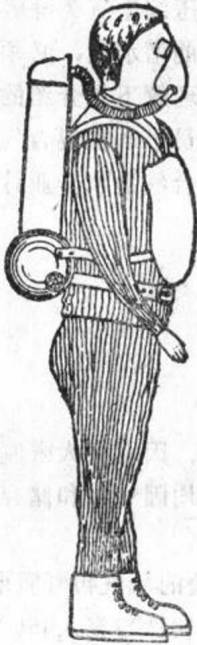
图9-1 弗勒斯装具：最早的 氧气再循环呼吸器
