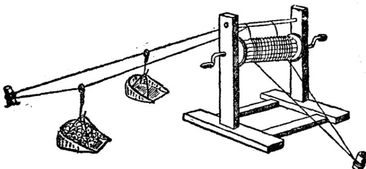
①適用範圍：從低處向高處運土，挖河泥筑壩均能適用。
