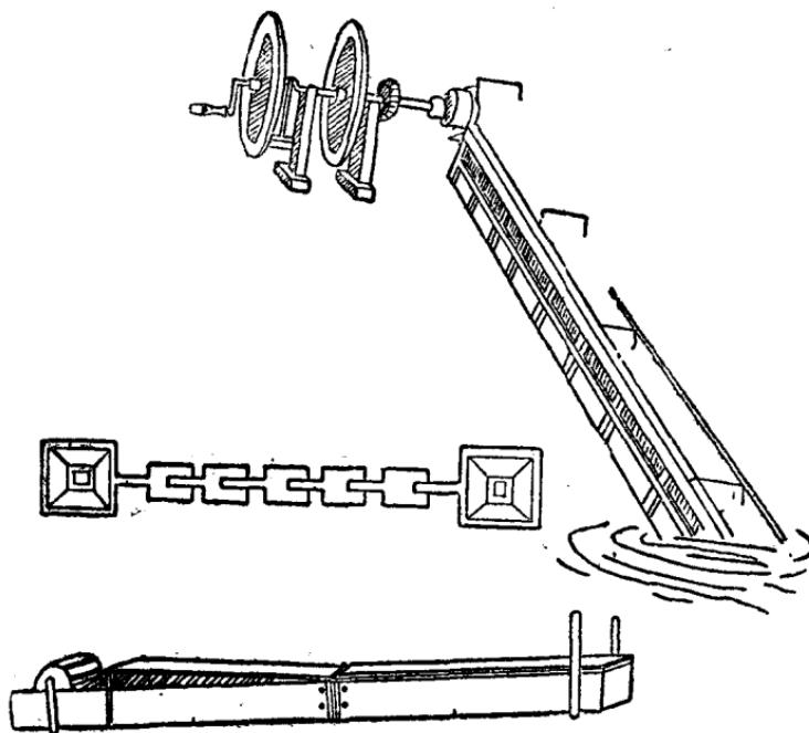
主要是利用空气吸力来增加水量，制造方法：将普通水車，在上水槽上面加板密封，使不透空气漏水，将普通車板兩块合一块，中間夾橡皮稍大于車板与普通車板十与一之比。(即普通十块車板的距离，这种水車上只須装一块)它的特点：效力高，可节约劳动力三分之一，搖起来輕便，节约車板，不易损坏。
