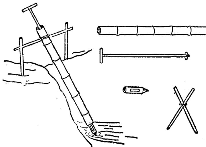
将一根毛竹中间贯通，然后用一根木棒，一头嵌上把手，另一头装橡皮（大小可根据毛竹口径而定）放入竹筒内，使用时上下抽动，竹筒下端用木制，挖空，以供吸水（象打气筒相同）水即能被抽上来。特点是结构简单，使用便利，成本低廉，出水量可抵上一部小水车，最适用于山区梯田。
