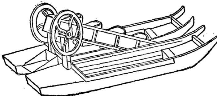
該机是根据嘉兴农械厂創制的动力捻泥机的原理改進而成。現在除了軸、齒輪用鐵制造外，余全部用木，它每天可捻泥 60 吨，較同样人数每天 15 吨提高三倍，河泥質量与人工相仿。每台成本 140 元左右，比新創的要减少十倍，用 4 ~ 5 人操作，而且可利用原来农船。最近嘉兴县对此机又作了改進，效率比人工提高五倍，成本只須 70 元，而且輕便。
