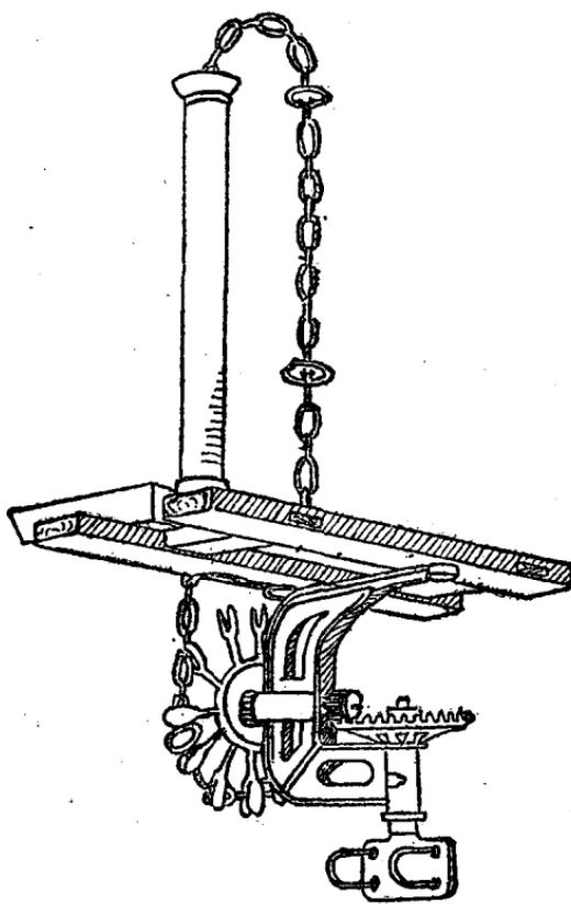
这是仿照华北解放式水車加以改進而制成。它利用空气吸力抽水。結構上除了在叶子上有橡皮之外，余均用鑄鐵，管子用鐵皮。它的特点：出水率高，能抵上3~4匹馬力抽水机，可以用风力、畜力、人力推动，还可以用动力，每台价格約170元左右。
