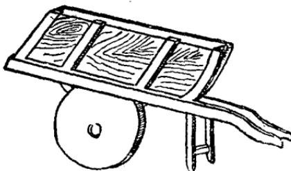
每次可運泥200斤左右，除了在平地上運送外，在田埂小道上也能運送，效率比人工提高一倍左右。
