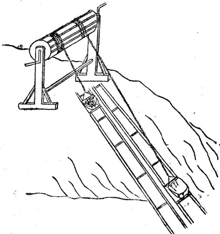
用毛竹做成二条轨道，在轨道上擺一活動木架，然后将裝滿土的土筐放在上面，搖動轆轤，即可將土从底处运往高处，效率比人工提高4~5倍。
