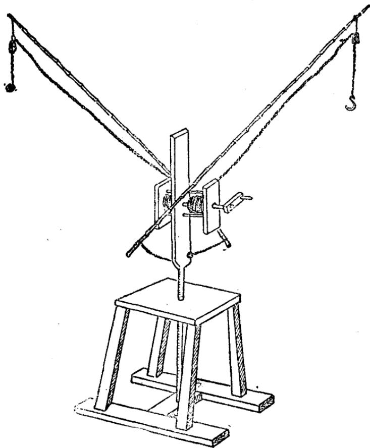
适用于从低向高处运泥土或重物，也可以用在从高处向低处运物或泥土。用木制成一个架子，中間放一軸心，在軸心中間穿上一鐵制橫軸，將二根毛竹裝在橫軸上，予以固定。使用时搖動后盤一放一裝，任意旋轉。共須六人操作，二人搖后盤，一人掌握轉向，二人裝土，一人倒土，每小時可吊 1.5 土方，造价約18元。
