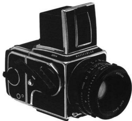
[图 1-4 Hasselblad 照相机是最为著名的 120 照相机，它的机身坚固耐用，而镜头选用德国的 Carl Zeiss 镜头，像质无可挑剔。Hasselblad 照相机分 500 和 200 两大系列，500 系列采用传统的机械控制模式，照相机的快门为镜间快门；200 系列则偏重于电子控制，照相机的快门为焦平面快门。]
