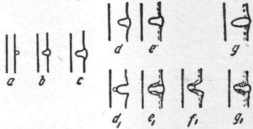
圖5 谷爾特格林和弗拉格滿的蜂窩氣泡形成圖解
