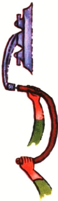
再拿一根橡皮管，裝滿水，然後把橡皮管兩頭捏緊，一頭放在這裏，另一頭放在水槽裏，水會經過水管到水槽裏去，這樣用樣子作虹吸管。
