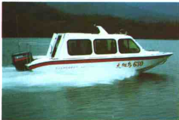
u630 快艇： 主尺度(m) 定员 配(HP)机 航速(km) 适应航区 6.3x1.9x0.7 8 85-115 50-60 内河 B 级
