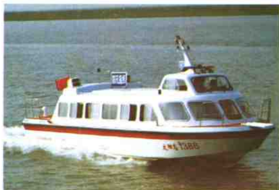
h1388 客船： 主尺度(m) 定员 配(HP)机 航速(km) 适应航区 13.8x3.9x1.35 54 280x2 台 50 内河 A 级
