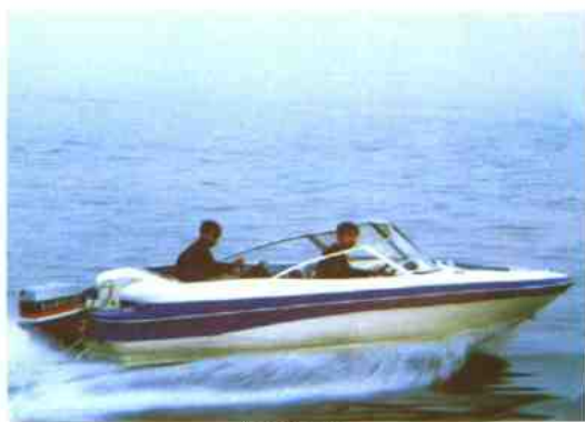
h518 高速快艇： 主尺度(m) 乘员 功率(kw) 航速(km) 适应航区 5.18x2.20x0.95 8 100-150 50-60 内河 A 级
