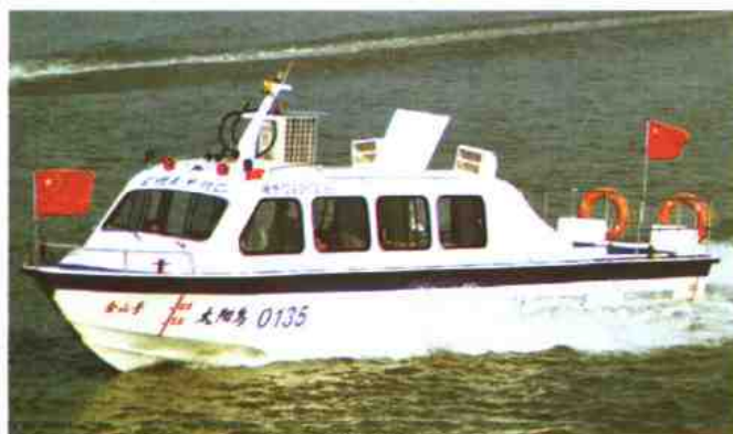
e-0135 客艇： 主尺度(m) 乘员 配(HP)机 航速(km) 适应航区 13.5x2.8x1.25 27 245-280 45-50 内河 B 级
