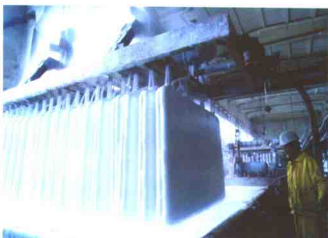
钛白粉过滤生产车间
