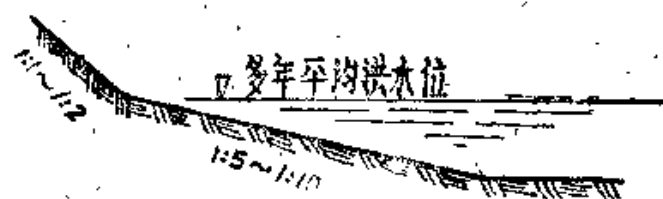
图1-5 浅河滩上多年平均洪水位示意图
