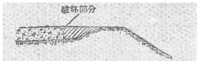
圖 4 路面邊緣的破壞
