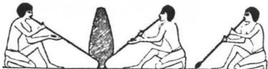
图 10 埃及的金属加工。上图：用芦管吹火，芦管头用黏土糊上；本尼·哈桑，公元前 1900 年。下图：制造铜瓶；底比斯，大约公元前 1550 年。
