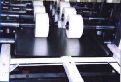
机电系研制的MKGY-670型门壳滚压成型机组在中国星星电器工业集团公司投入应用。该设备构思新颖，在国内外同类设备中具有领先水平。
