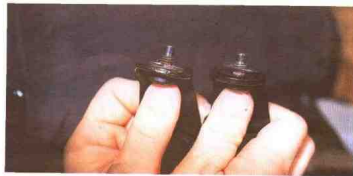
第一次撞车时: 拽脱的安全带螺丝 (右)
