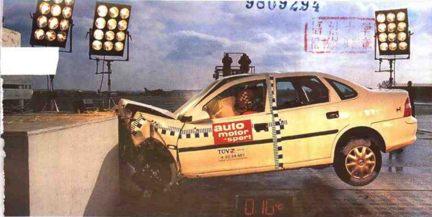
第一次撞车: 62 毫秒后, 安全带固定螺丝拽脱
