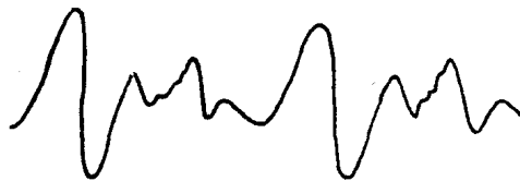
图 12 人工喉激励的空气波形
