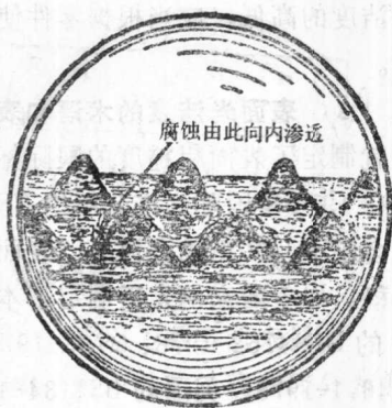
图4 在腐蚀影响下的表面被破坏的略图
