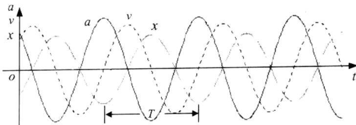
显然, 速度和加速度都是简谐量, 角频率仍为  $\omega$ , 速度的相位超前位移  $\pi/2$ , 加速度的相位超前速度  $\pi/2$ , 与位移反相。
