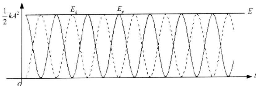
弹簧振子自由振动满足机械能守恒条件，机械能守恒是意料之中的。振子机械能与振幅平方成正比。对于振子的简谐振动，振子动能和势能的瞬时值此长彼消，都做周期性变化，角频率为 $2\omega$ 。将(1.1-5)式对时间取微商，得  $m\ddot{x} + kx = 0$
