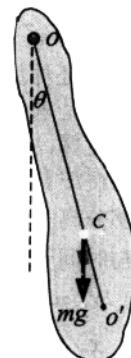
若将这个复摆悬挂于过  $o'$  点的水平轴,  $o$  点成为振动中心, 复摆振动周期不变(可逆摆)。此时, 复摆振动的微分方程为
