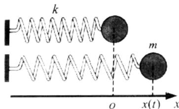
根据 Hooke 定律和 Newton 第二定律  $-kx = m \frac{d^2x}{dt^2}$  令  $\omega^2 = \frac{k}{m}$  得动力学方程
