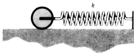
[例题 1.2.6] 求弹簧质量  $m$  不可忽略的弹簧振子自由振动频率。设弹簧劲度是  $k$ ，质点质量为  $M$  ( $M \gg m$ )。
