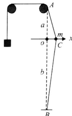
解：设  $ox$  垂直于静态弦线，它们的交点为原点。横向运动时小球的坐标为  $x$ ，它所受到的回复力为  $\frac{x}{a}F + \frac{x}{b}F$
