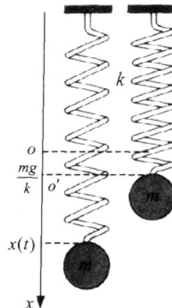
[例题 1.2.4] 两个原长不同, 劲度分别为  $k_1, k_2$  的理想弹簧串联, 与质点  $m$  组成振子, 求自由振动频率。
