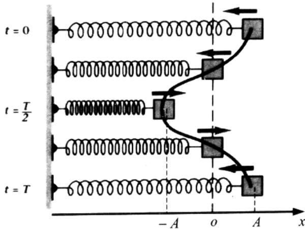
[例题 1.1.1] 求弹簧振子自由振动的振幅和初相, 已知  $x(0) = x_0$ ,  $v(0) = v_0$
