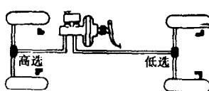
四个轮子各装置一个传感器，两前轮一起控制，两后轮亦一起控制。
