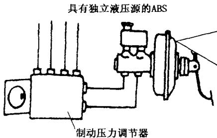
分体式 ABS 的制动压力调节器为独立总成，通过制动管路与制动主缸和制动轮缸相连，其突出优点是零部件安装灵活，适合于 ABS 作为选装部件时用。Bosch 2S 型、Bosch 2E型、本迪克斯 (Bendix) IV型、VI型就属于分体式ABS，桑塔纳、捷达、红旗和沃尔沃等轿车亦均采用分体式ABS。
