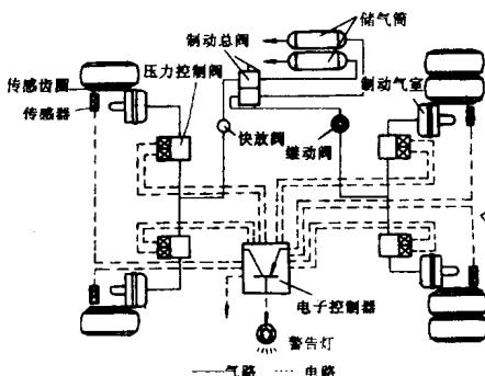
对大中型汽车、牵引车及挂车等采用气压制动系统的车辆来说，其ABS系统的组成有相异之处。气压制动系统(F/A)汽车的ABS系统直接控制制动分泵的气压压力，不需要在原有的制动系统中增加另外的部件，能较容易地独立控制各车轮的制动力。
