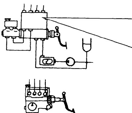
整体式 ABS 的制动压力调节器与制动主缸以及制动助力器组合为一个整体, 其优点是结构紧凑, 节省安装空间, 一般都作为汽车的标准装备来采用。戴维斯ATE 型、德尔科型和 Bosch 3 型均为整体式 ABS。整体式 ABS 结构复杂, 成本较高, 高级轿车采用较多。
