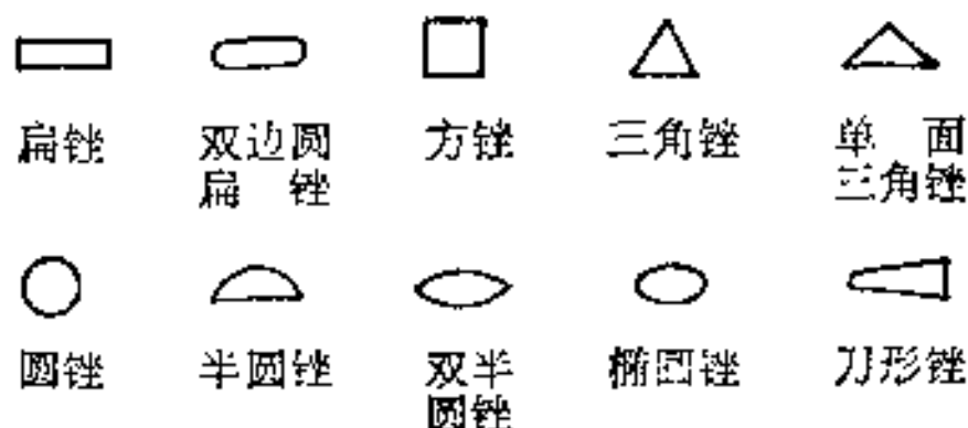
各种整形锉的断面形状
