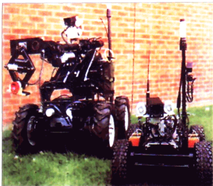
英国陆军用于侦察和处理爆炸危险品的遥控电动车，曾用于波黑地区和科索沃
