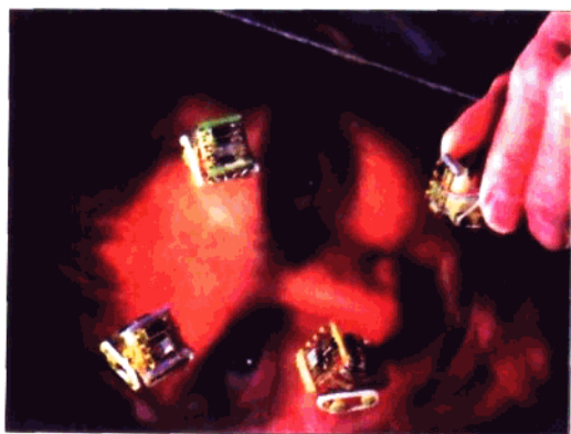
美国圣地亚哥国家试验室研制的最小的“自主无系留机器人”，体积小于4厘米 3 ，重量小于30克 [3]
