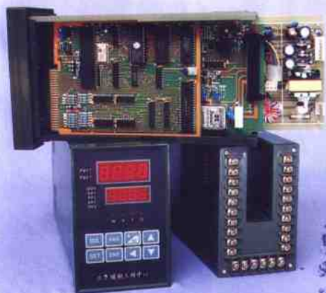
○北京模糊工程中心开发研制的通用可编程模糊逻辑控制器。
