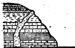
图 6 充填于沉积岩层裂縫中的块状岩脉
