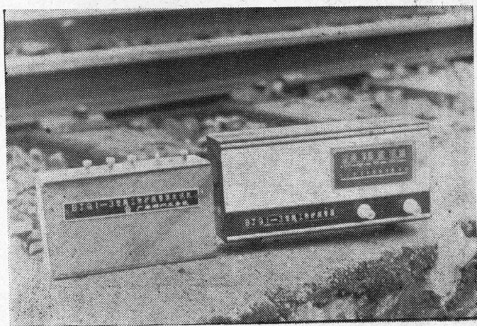
(乙) 发射机与接收机 图 1—2 BJQ1-3型报警器
