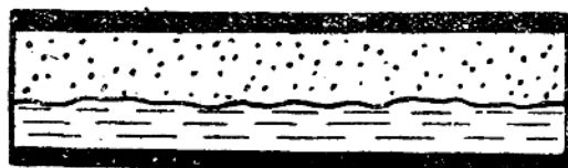
图 3-7 汽水混合物的分层工况
