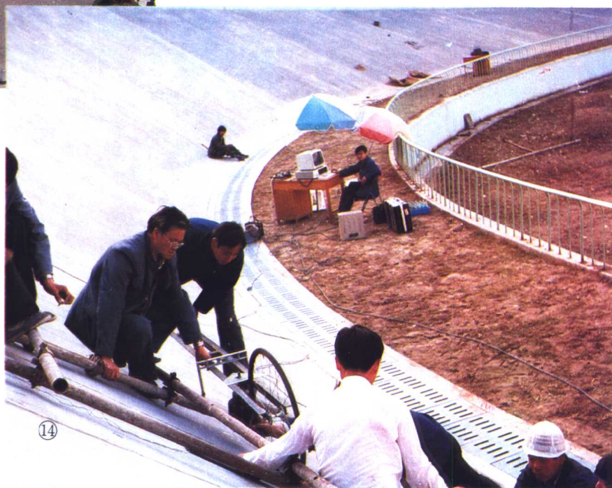
14 昌平自行车赛场摩擦系数检测
