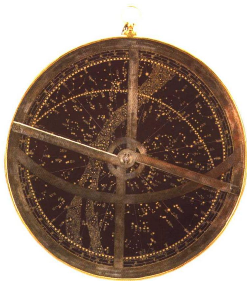
简平仪 清 用于拟定夜晚星象或星位，白天根据日影的变化确定时间。
