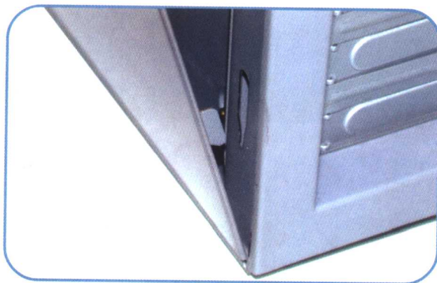
◎在把机箱装好的时候要将倒钩插入箱体上的插孔。
