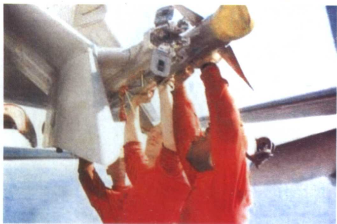
“沙漠之狐”行动第二天，美海军企业号航母上的技师正在为F-14熊猫式战斗机装载AIM-9响尾蛇式高空导弹。熊猫式战机将为空袭机群提供护航任务。
