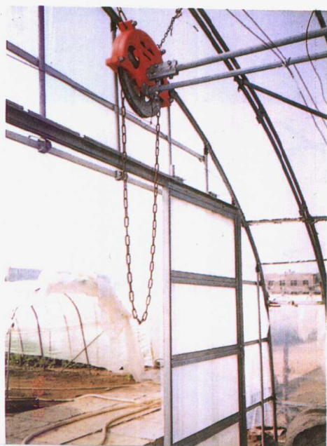
◀ 管架大棚二道幕开闭的拉链葫芦盘及推拉门设置
