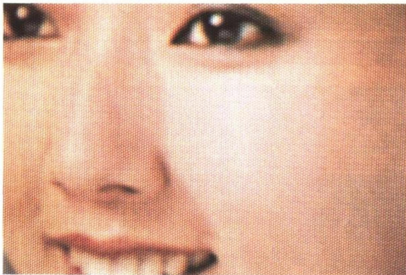
图8.1 CRT显像管的放大图 （图像由红、绿、蓝的点光源构成）
