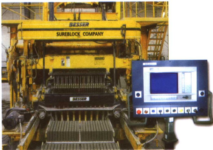
高频、高压、模振全自动成型系统
