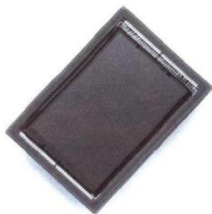
图 02-02 使用于佳能 EOS-1Ds 型相机的 CMOS (36X24mm)。
