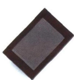
图 02-01 使用于佳能 EOS-1D4型相机的CCD。
