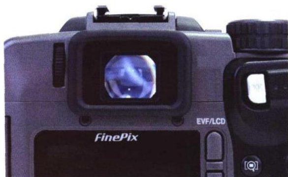
图02-04 EFV电子取景器 和传统相机的取景器相仿。
