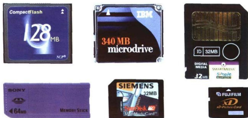
图 03-01 图为各种不同的存储卡。依次为 CF 卡、Microdrive、SM 卡、记忆棒、MMC 卡和 xD 卡。
