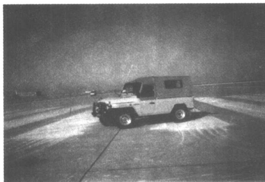
图 5 跑道病害车载雷达探测
